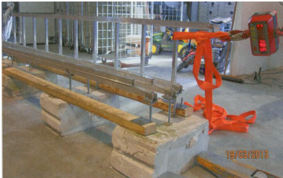
Bild 1. Belastning av utrymningsstegen.
